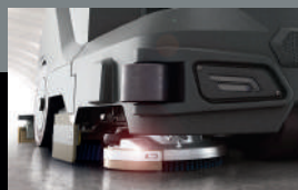
Trzecia szczotka boczna Zwiększa efektywność czyszczenia wzdłuż ścian (dostępna dla wersji Ehle 110/75 R z dyskiem).
